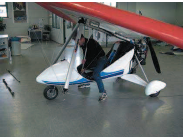
Abb. 9: Steigen Sie erneut seitlich über die Gondel und drücken Sie den Trike-Mast nach oben.
