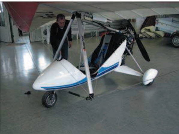
Abb. 7: Der Skycruiser steht jetzt in "geduckter Stellung" auf dem Hilfsrohr. Die Trapezbasis befindet sich zwischen Gondel und Boden.
