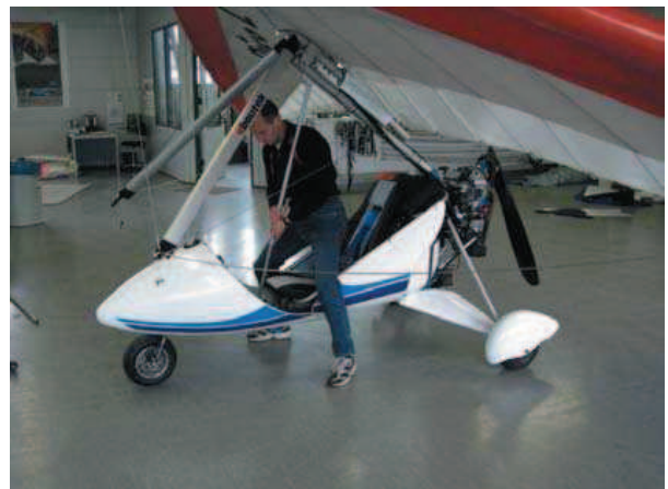
Abb. 10: Sie können auch von vorne die beiden Trapezecken greifen und nach oben drücken, bis alle Schnapper ausgerastet sind.
