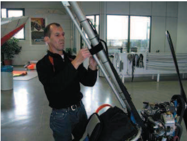
Abb. 1: Klappen Sie den Trike-Mast nach oben und lösen Sie das Klettband des Hilfsrohrs.
