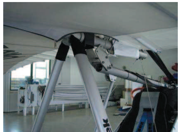
Abb. 4: Befestigen Sie die Hangpoint-Platten am Mast mit dem Kunststoffklotz am Kielrohr des Pico L.
