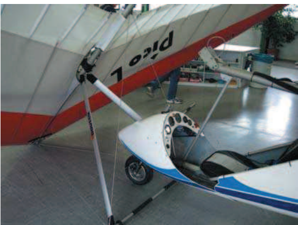
Abb. 3: Fahren Sie mit dem Vorderrad des Trikes in das Trapezdreieck des aufgebauten Pico L.
