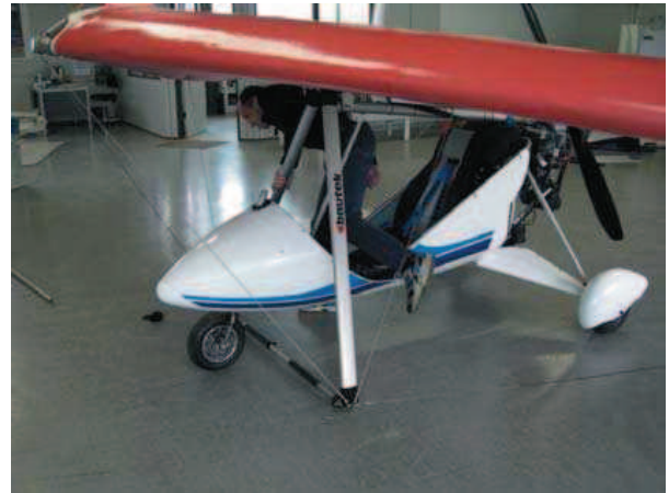
Abb. 6: Steigen Sie von der Seite hinter dem Hilfsrohr über die Gondel und heben Sie mit der Schulter und am Hilfsrohr die Fläche an, bis ein Schnapper das Hilfsrohr in der ersten höheren Position sichert.
