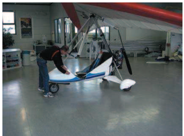
Abb. 16: Bringen Sie die Mastverkleidung und die Windschutzscheibe an.
