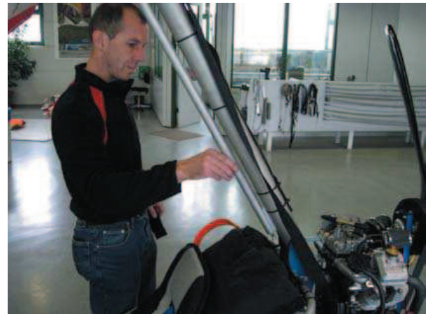
Abb. 2: Befestigen Sie das Ende des Hilfsrohrs durch einen Bolzen mit Gummikordel in der U-Schiene am Hauptrohr vor dem Sitz.
