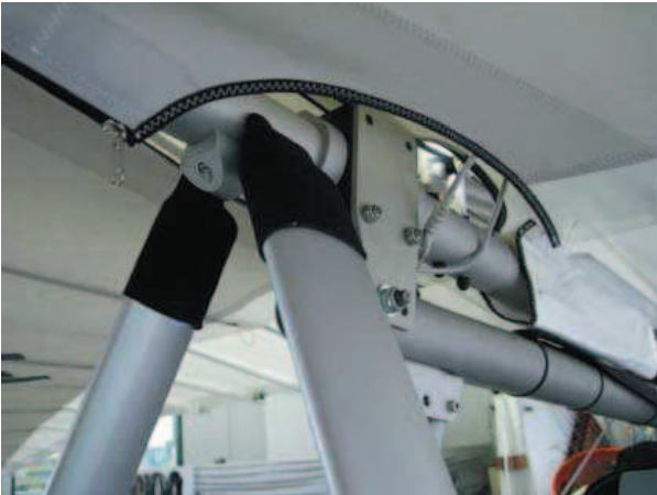
Abb. 5: Schieben Sie die beiden oberen Schrauben durch den Hangpoint und sichern Sie die Schrauben mit Fokkernadeln.
