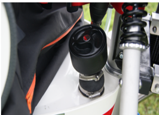
Tankschloss abschließen und Benzin-Handpumpe betätigen bis Sprit oben in der Schwimmerkammer ansteht. Danach Propeller noch 3 mal nach links drehen, damit die Benzinpumpe arbeitet.
