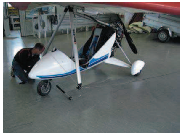
Abb. 8: Lösen Sie die Trapezbasis von den beiden Trapezecken.
