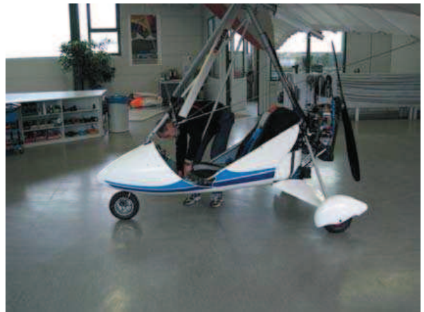
Abb. 14: Lösen Sie das Hilfsrohr vor dem Sitz vom Hauptrohr (Bolzen mit Gummikordel).
