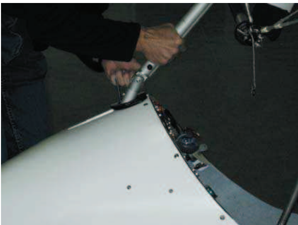
Abb. 13: Schrauben Sie das Frontrohr auch unten an der Gondel fest.
