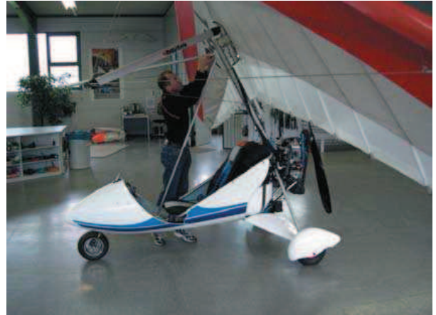
Abb. 12: Befestigen Sie das Frontrohr oben am Mast.
