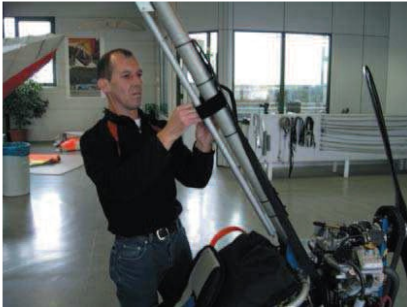
Fig. 1: Pliez le Trike-mât et desserrer le Velcro du tuyau auxiliaire
