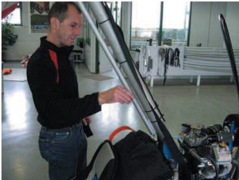
Fig 2.: Attachez l'extrémité du tube auxiliaire par un boulon avec un cordon en caoutchouc dans le rail en U sur le tuyau principal avant le siège.
