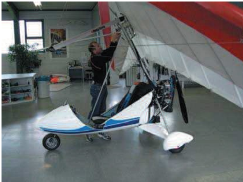
Fig. 12: Fixer le tube avant en haut sur le mât.
