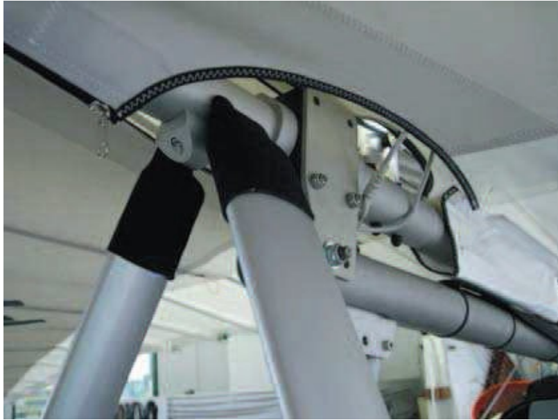
. Figure 5: Faites glisser les deux vis à travers le point de colline et serrez les vis avec Fokkernadeln.
