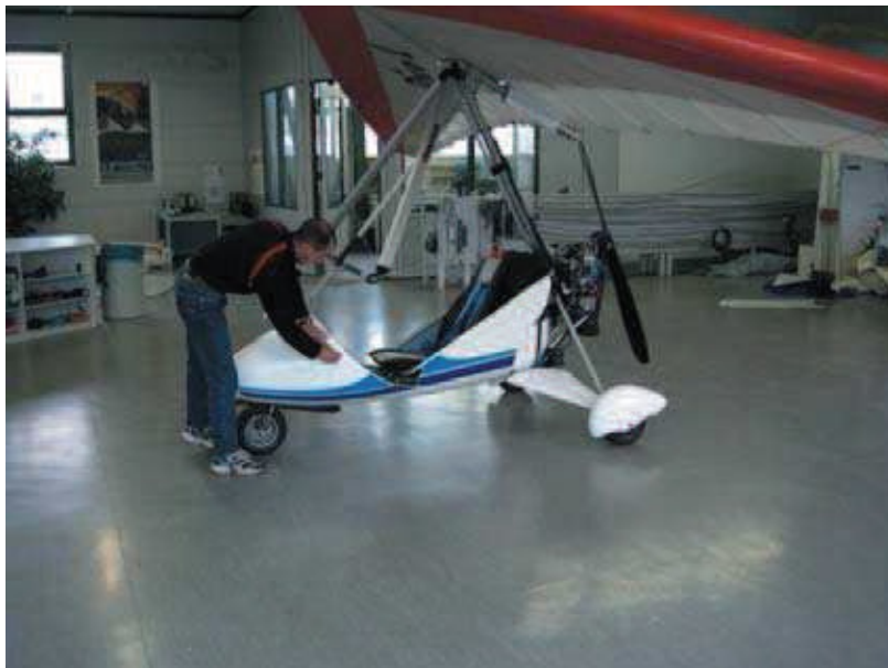
Fig. 16: Fixer le carénage de mât et le pare-brise.
