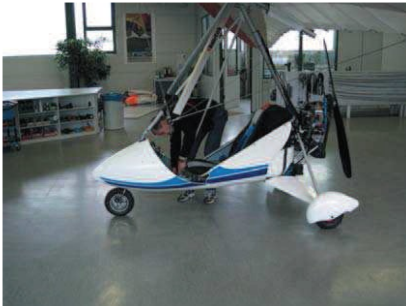
Fig. 14: enlever le tuyau avant auxiliaire du siège sur le tuyau principal (boulon avec cordon élastique).
