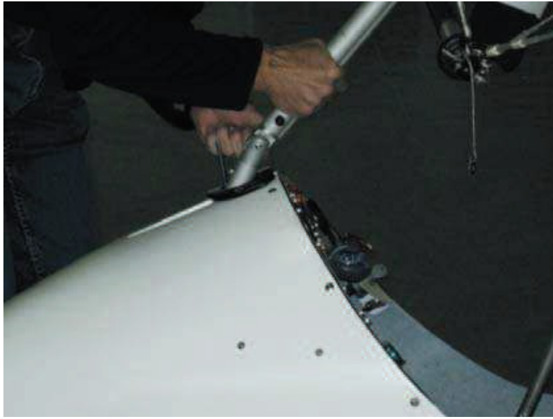
Fig. 13: Vissez le tube avant et fermement sur la nacelle.
