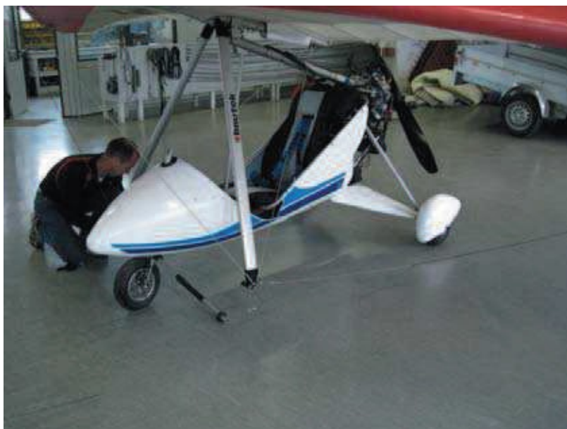
Fig. 8: Desserrez la base trapézoïdale les deux coins de bar.
