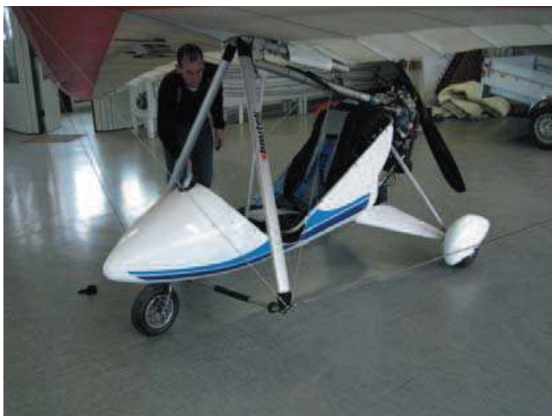
Fig. 7: Le Skycruiser est maintenant en "Position accroupi" sur le tuyau auxiliaire. La base trapézoïdale est située entre la nacelle et le sol.
