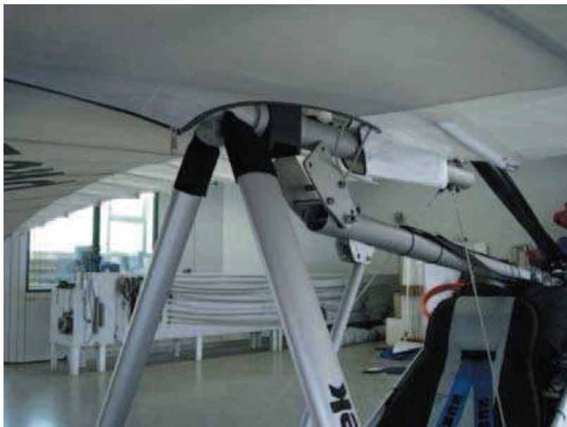
Fig. 4: Fixez les plaques de point de pente du mât avec le bloc en plastique sur la quille Pico L
