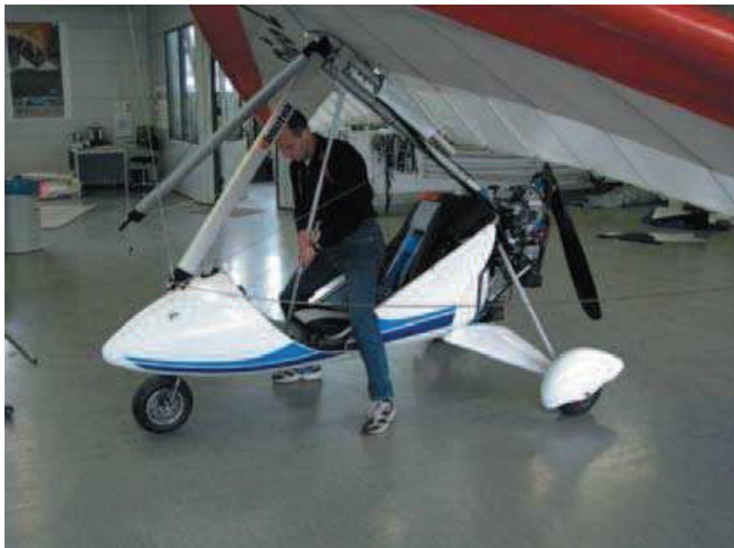
Fig. 10: Vous pouvez accéder à partir de l'avant, les deux coins trapézoïdales et pousser vers le haut jusqu'à ce que tous les vivaneau sont désengagés.
