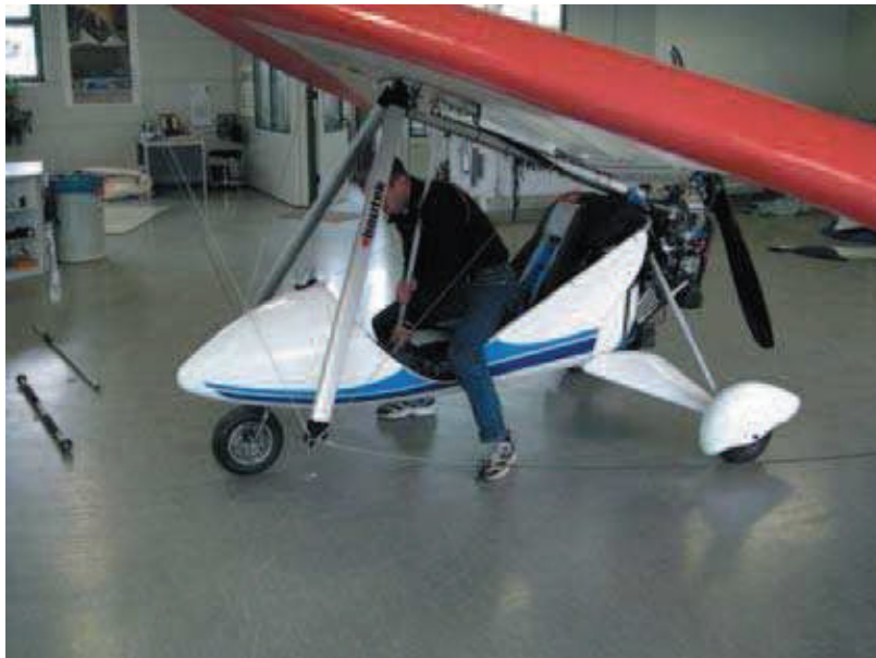
Fig. 9: Montez à nouveau latéralement sur la nacelle et appuyez sur le Trike-mât vers le haut.
